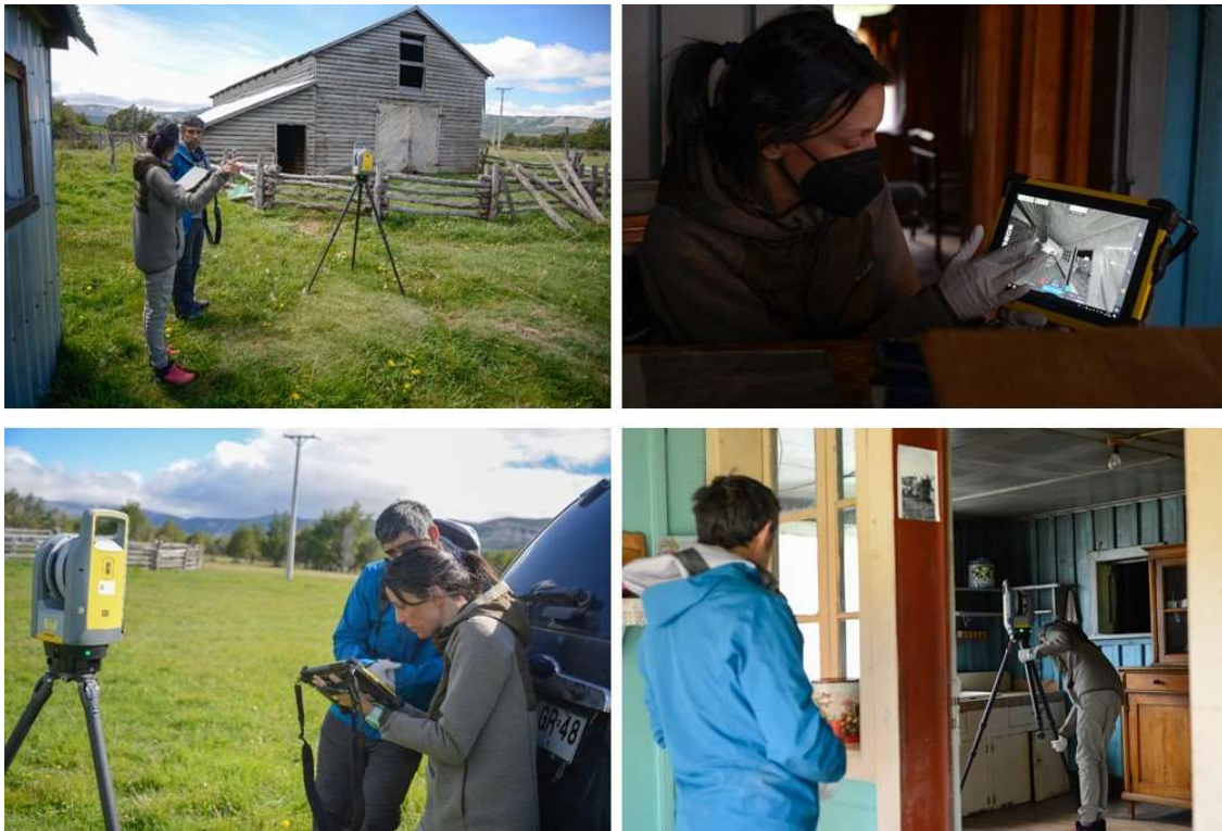
Figura 2. Proceso de medición con el escáner Trimble X7 3D, fundo Cerro Galera. (Elaboración proyecto FONPAT Folio N° 36587, 2022)
