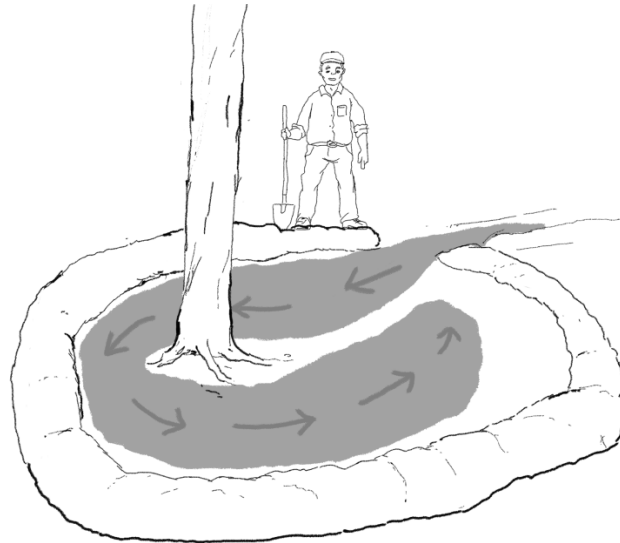
Figura 8. Circulación del agua en las eras durante la actividad del riego
